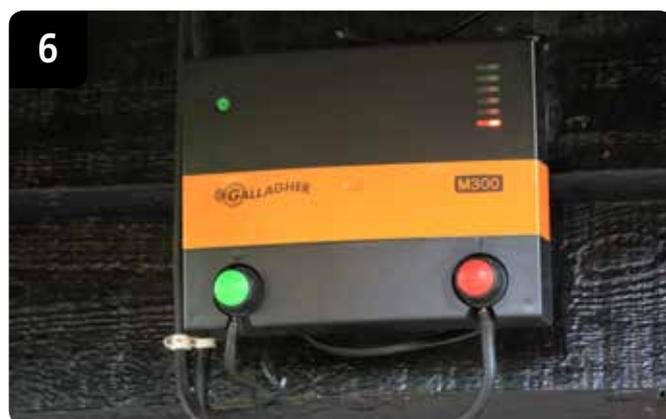
Montez l'électrificateur et la mise à la terre
